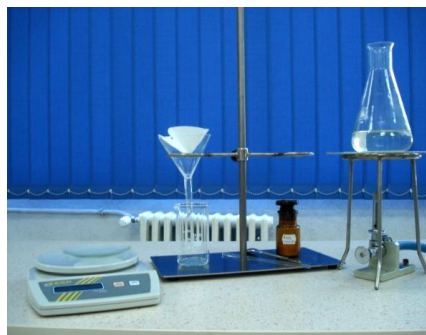
Fig. III.6. Instalație de cristalizare
