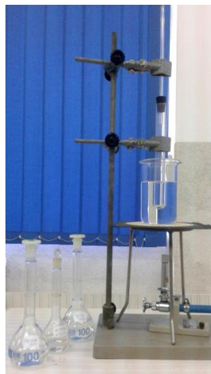
Fig.V.9. Instalația de esterificare
